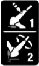
Presione y gire para cambiar la posición de corte
